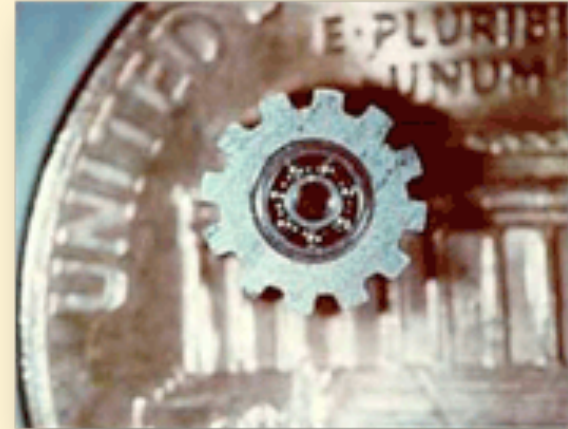
LIGA-micromachined gear for a mini electromagnetic motor
